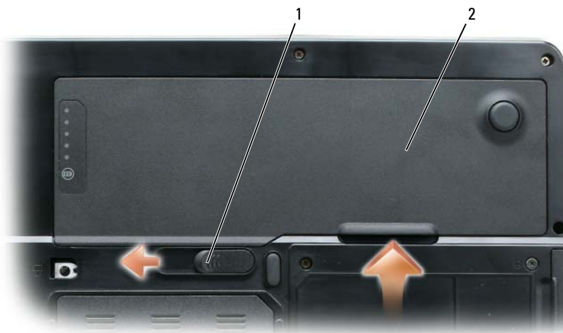
1 aba de liberação da trava do compartimento de bateria 2 bateria
